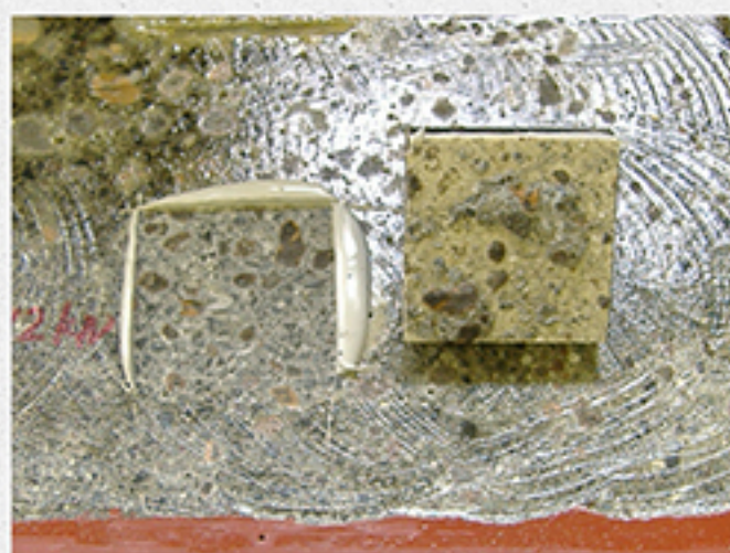
破断面の様子 →下地に食い込んでいる様子がわかります
